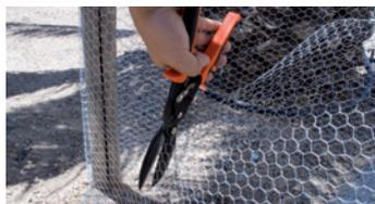
Idéal pour couper le treillis soudé souple simple torsion et grillage à lapin
